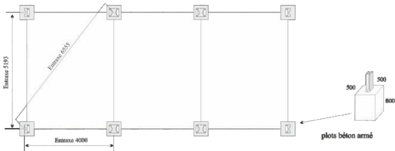
Si un portail doit être installé sur le pignon ou le long pan, prévoir une longrine de 300/200 sur une longueur de 2 fois le vantail
